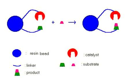
图 3 应用一珠一化合物方法构建一个化合物库以搜选人工催化剂. 底物上可以用同位素, 荧光物质等标记以方便检测催化产物, 也可以用针对产物的抗体来筛选. 从而进一步扩展了该策略的普适性.
